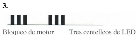
Possible solución: revisar si algún objeto se encuentra produciendo una traba mecánica en el motor o en la máquina.
